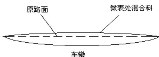
图 3.5.11 微表处车辙摊铺应当高出原路面
